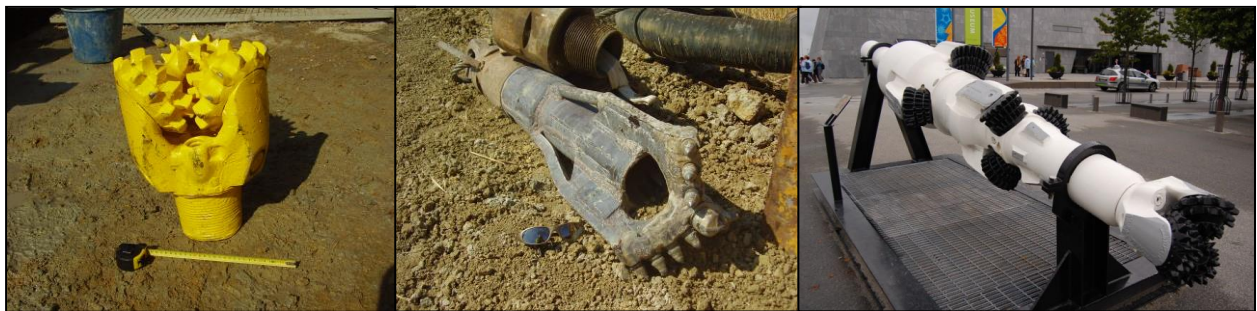
Fotos 4, 5 y 6.- Herramientas de perforación usadas en sistemas de rotación (de izquierda a derecha: tricono, trialeta y policono).
